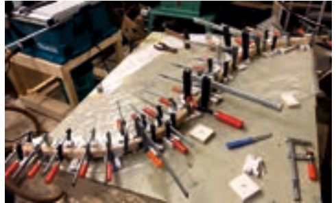
Schraubzwingen halten den neuen Spant in der gewünschten Form
