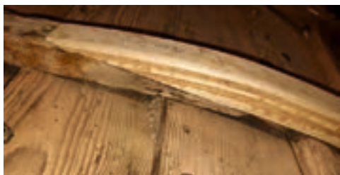
Das neue Spantsegment fertig zum Anschäften
